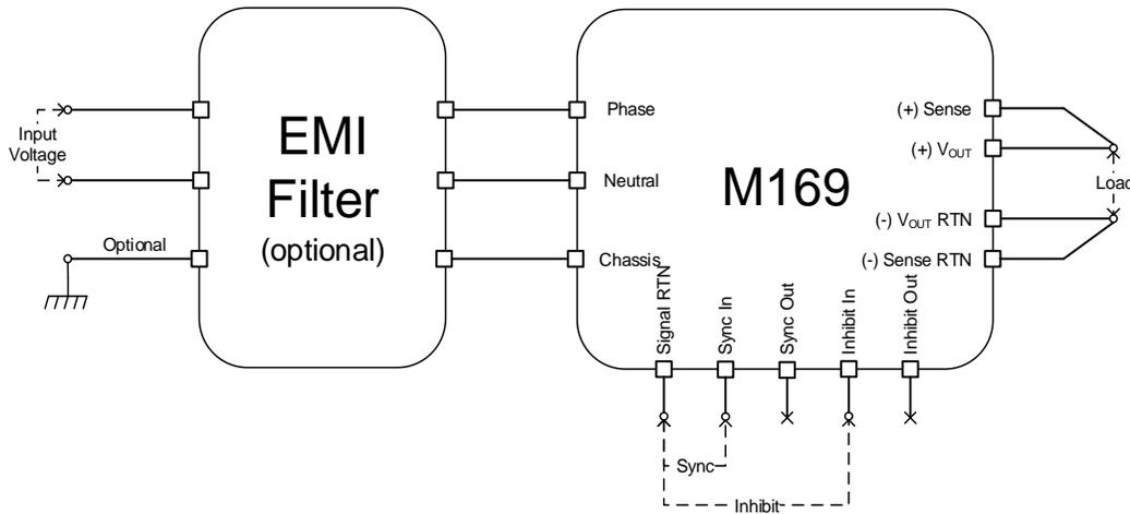
**TYPICAL PARALLEL CONNECTION DIAGRAM**
